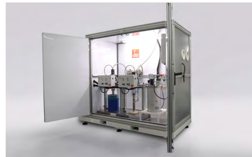
Oben: Zahnradpumpen stellen eine zuverlässige und prozesssichere Förderung des Materials sicher
