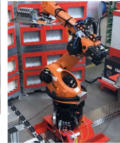
Individuelles Dosiersystem für das Vergießen: Ein Roboter übernimmt das gesamte Handling der Bauteile.
