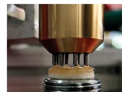
Beölung mit einem Nadeldosierventil sowie einem speziellen Adapter.
