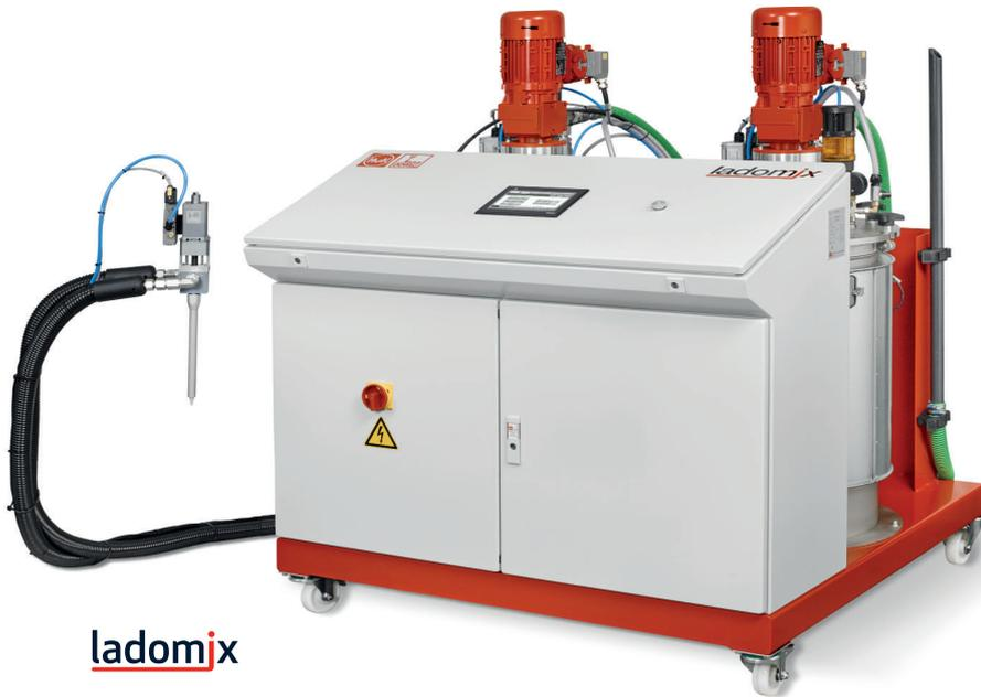
Die ladomix ist eine kompakt aufgebaute, mobile Dosier- und Mischanlage für das Laminieren in der Verpackungsindustrie. Mit ihr lassen sich lösemittelfreie, selbstnivellierende 2K-Kaschierklebstoffe aus Polyurethan in einem Mischungsverhältnis von 100:100 bis 100:10 dosieren und mischen. Das Material wird anschließend in den Spalt zwischen den Walzen der Laminiermaschine dosiert und auf die äußere Folie der Verpackung aufgebracht. Anschließend wird diese mit der inneren Folie verklebt.
