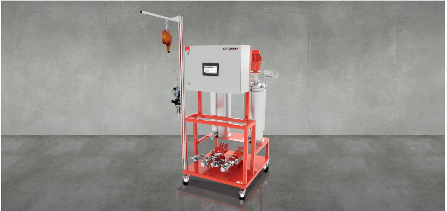
Die compomix FI wurde speziell für das Imprägnieren von Fasermaterialien bei den Anwendungen Vakuuminfusion, Resin Transfer Moulding (RTM), Pultrusion und Filament Winding konstruiert. Sie dosiert und mischt zweikomponentige Materialien, mit denen anschließend Glas-, Aramid- oder Kohlefasern imprägniert werden (Fibre Impregnation / FI). Je nach Applikation kann mit dem Dosiersystem
